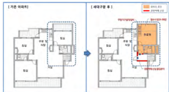
[그림 3-3-38] 세대 구분형 공동주택 예시
